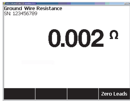
Figura 9. Medición de la resistencia de tierra del dispositivo bajo prueba
