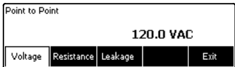
Figura 30. Menú de la función punto a punto
