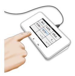
¡Sugerencia! Pulse un parámetro para aumentar el tamaño de los dígitos, obtener información del parámetro y, si procede, visualizar la forma de onda. Alterne entre ellos deslizando el dedo lateralmente.
