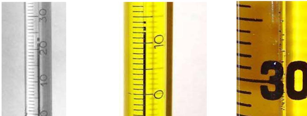
Figura 5. Ejemplos de tipos de separación de líquido
